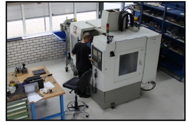
FIRST MCV-300 CNC bewerkingscentrum. 3-assig simultaan. Machine bereik 800 x 500 mm.
