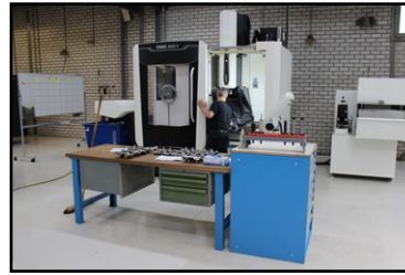
DMG CMX 800 V CNC bewerkingscentrum. 3-assig simultaan. Machine bereik 800 x 500 mm.
