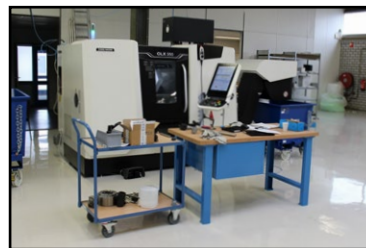
DMG CLX 350 Aangedreven gereedschappen. Maximale bereik: Ø190 x L580 mm.
