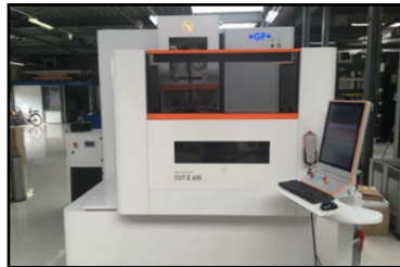
AGIECHARMILLES CUT E 600 Draaderodeermachine. Machine bereik: 600 x 400 x 350 mm. Minimale draaddikte: 0,10 - 0,30 mm.
