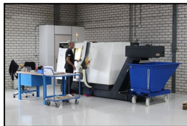
DMG CTX 310 Aangedreven gereedschappen. Maximale bereik: Ø150 x L350 mm.
