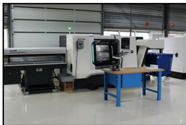
DMG CTX 500 ALPHA (2 Units) Aangedreven gereedschappen. LNS Staafaanvoer. Maximale bereik: Ø200 x L700 mm.
