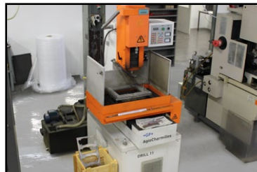
AGIECHARMILLES DRILL 11 Startgatboormachine. Machine bereik: 300 x 200 x 300 mm. Elektroden diameter: 0,3 -3,0 mm.
