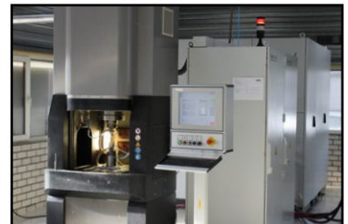
PEM600 PECM machine. Machine bereik: 590 x 740 mm. Vermogen: 7200 A.
