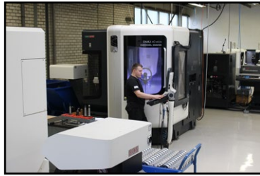
DMG DMU 40 EVO CNC bewerkingscentrum. 5-assig simultaan. Machine bereik: 400 x 400 x 375mm.
