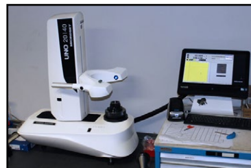
DMG UNO 20-40 Instel- en meetapparaat voor tools.
