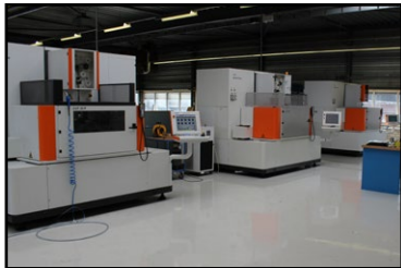
AGIECHARMILLES CUT 30 P (3 Units) Draaderodeermachine. Machine bereik: 600 x 400 x 350 mm. Minimale draaddikte: 0,10 - 0,30 mm.
